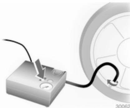
Wenn der Reifendruck mehr als 1,3 bar beträgt, auf den vorgeschriebenen Wert korrigieren. Vorgang wiederholen, bis kein Druckverlust mehr auftritt.
