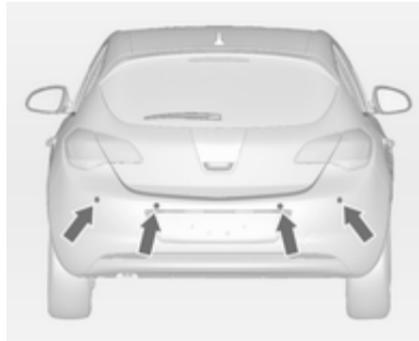
Das System besteht aus vier Ultraschall-Parksensoren im hinteren Stoßfänger.
