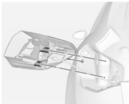
4. Rückleuchtenszusammenbau vorsichtig aus der Aussparung nehmen und entfernen. Darauf achten, dass der Kabelkanal nicht verschoben wird.
