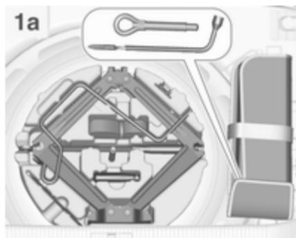
Wagenheber, Wagenwerkzeug und ein Gurt zur Befestigung eines beschädigten Rades befinden sich im Werkzeugkasten unter dem Reserverad im Laderaum. Der Radschlüssel und die Abschleppöse befinden sich in der Werkzeugtasche, die in der Nähe des Werkzeugkastens in der Reserveradaufnahme verstaut ist. Reserverad ⇨ 288.
