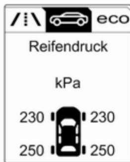
Reifendruck-Kontrollsystem durch Drehen des Einstellrädchens wählen. Systemstatus und Druckwarnungen werden durch eine Meldung und gleichzeitiges Blinken des betreffenden Reifens im Driver Information Center angezeigt.
