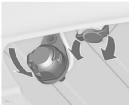
Die Steckdose austrasten und nach unten klappen. Den Verschlussstopfen von der Öffnung für die Kugelstange entfernen und verstauen.
