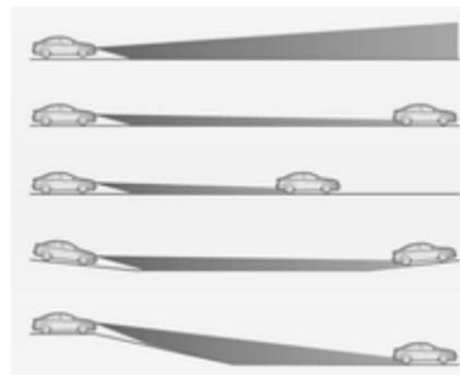
Eine spezielle topografische Bewertungsfunktion erkennt vorausfahrende Fahrzeuge an Steigungen oder Gefällen, indem es die Bewegung der Rückleuchten auswertet. Das System passt die Leuchtweithöhe so an, dass die Straße optimal ausgeleuchtet wird, ohne andere Verkehrsteilnehmer zu blenden.
