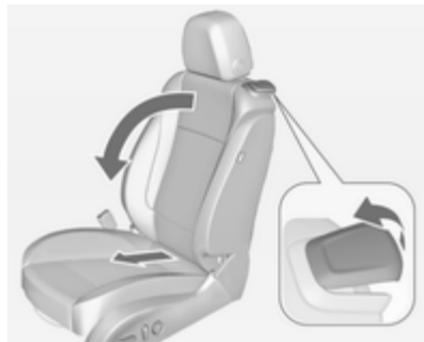
Entriegelungshebel anheben und Sitzlehne nach vorn klappen. Der Sitz wird automatisch bis zum Anschlag nach vorne verschoben.
