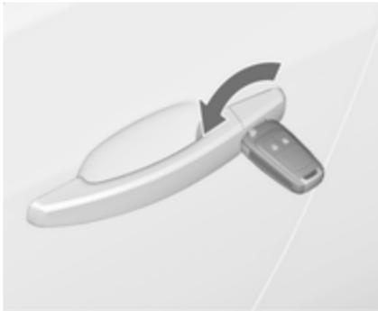
Fahrtür durch Drehen des Schlüssels im Schloss manuell entriegeln. Zündung einschalten und Zentralverriegelungstaste
