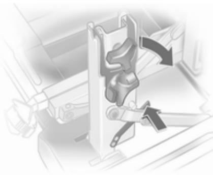
Den Arretierungshebel an der diagonalen Stütze ausrasten und beide Tretkurbelbefestigungen nach unten klappen.
