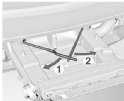
Zuerst den linken Spannhelm (1), danach den rechten Spannhelm (2) bis zum Anschlag schwenken.
