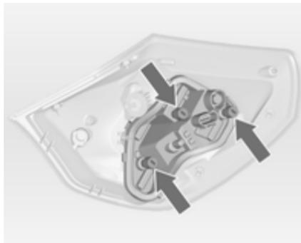
6. Die drei Schrauben mit einem Schraubendreher lösen und die Lampenfassung vom Leuchtenzusammenbau abnehmen.
