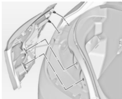
3. Den Rückleuchtenzusammenbau vorsichtig aus der Aussparung nehmen und entfernen. Darauf achten, dass der Kabelkanal nicht verschoben wird.
