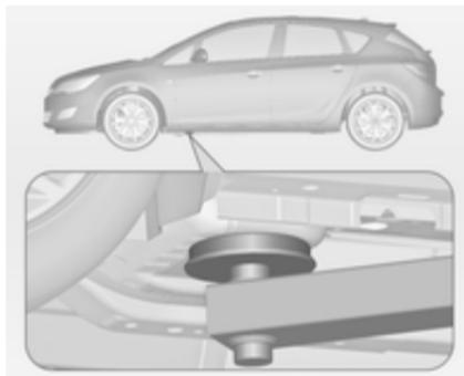
Position des vorderen Hebebühnenarms am Unterboden.
