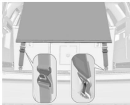
Unteren Haken mit der Öffnung nach hinten in die Ösen rechts und links am Boden einhaken. Gurtlänge des Sicherheitsnetzes durch Einhängen des oberen Hakens in die Gurtösen einstellen. Während des Einbaus der Stange den Gurt gespannt halten.
