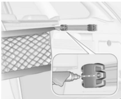
Adapter in die erforderliche Position in den Schienen einsetzen. Die Hälften der Netzstangen zusammenstecken.
