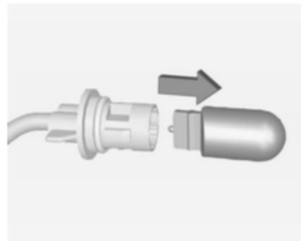
3. Die Lampe aus der Fassung ziehen und ersetzen.
