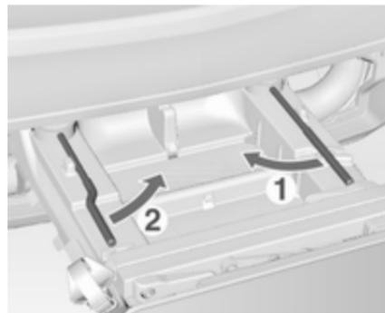
Erst den rechten Spannhebel (1) und dann den linken Spannhebel (2) schwenken, bis ein Widerstand zu spüren ist.
