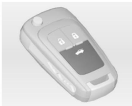
Durch Drücken der Taste
