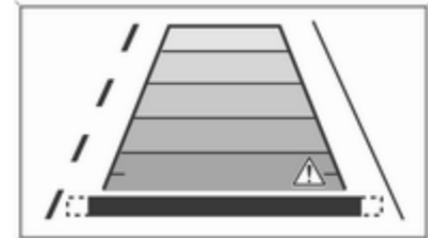
Dank der hohen Lage der Kamera wird auch der Heckstoßfänger auf dem Bild angezeigt und bietet so eine gute Orientierungsmöglichkeit.
