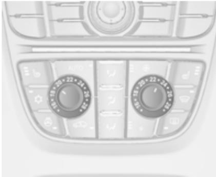
Ist die Mindesttemperatur **Lo** eingestellt, läuft die Klimaanlage mit maximaler Kühlung, sofern die Kühlung
