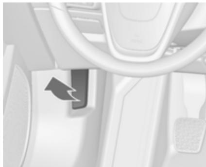
Entriegelungshebel ziehen und in die Ausgangsposition zurückführen.
