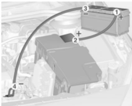
Reihenfolge für das Anschließen der Kabel:
