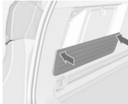
Beim Zusammenbau Sonnenrollo in die Gummifüllungen drücken, um volle Haltekraft zu erreichen.
