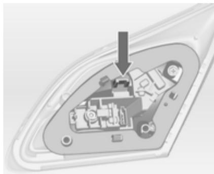
4. Auf die Haltenase drücken und die Lampenfassung aus dem Leuchtensammenbau herausnehmen.
