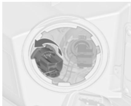
2. Lampenfassung gegen den Uhrzeigersinn drehen, um sie auszurasten und aus dem Reflektor zu entnehmen.
