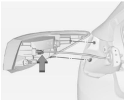
3. Rückleuchtensammenbau vorsichtig aus der Aussparung nehmen und entfernen. Darauf achten, dass der Kabelkanal nicht verschoben wird.
