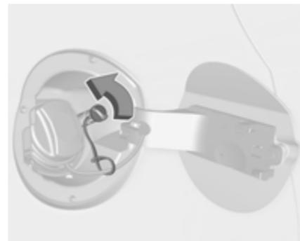
Die Schutzkappe vom Einfüllstutzen abschrauben.
