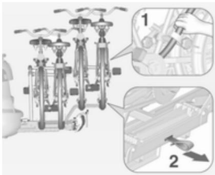
Den Rahmen (1) des hintersten Fahrrads mit einer Hand halten und zum Lösen des Trägers an der Schlaufe (2) ziehen.
