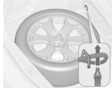
2. Das Schlaufenende des Gurtes durch die vordere Zurröse an der entsprechenden Seite führen.
