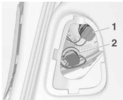
2. Die Lampenfassung durch Drehen ausbauen und die Lampe ersetzen. Hierzu die Lampe herausziehen oder leicht in die Fassung drücken und gegen den Uhrzeigersinn drehen:
