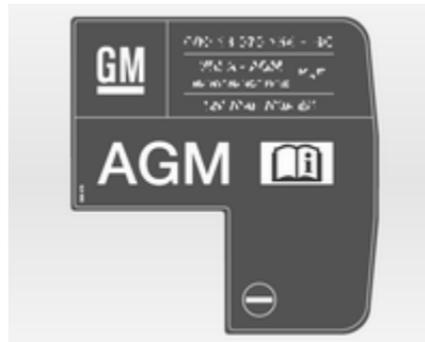
AGM-Batterien sind am entsprechenden Batterieschild zu erkennen. Wir empfehlen den Einsatz einer original Opel-Fahrzeuga-batterie.
