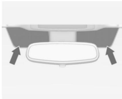
Die markierten Bereiche auf der Windschutzscheibe sind nicht beschichtet. Geräte für das Aufzeichnen von elektronischen Daten bzw. für die Gebührenbezahlung müssen in diesen Bereichen befestigt werden. Andernfalls treten möglicherweise Störungen beim Aufzeichnen der Daten auf.
