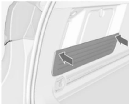
Bei Zusammenbau die Blende auf der linken Seite in die Gummitülle drücken, um volle Haltekraft zu erreichen.
