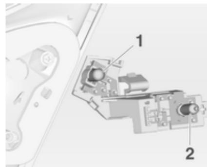
5. Die Lampe ausbauen und ersetzen. Hierzu die Lampe herausziehen oder leicht in die Fassung drücken und gegen den Uhrzeigersinn drehen:
