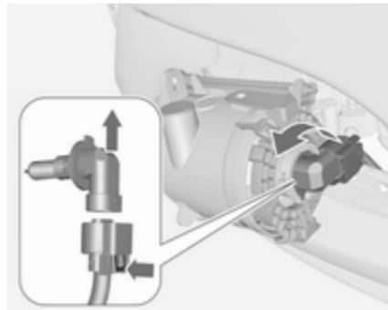
3. Die Lampenfassung nach links drehen und aus dem Reflektor herausnehmen.
