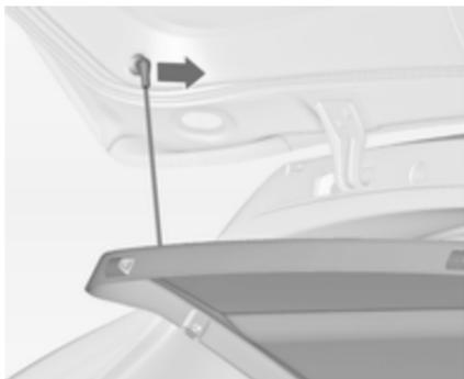
Befestigungsgurte von Hecktür lösen.
