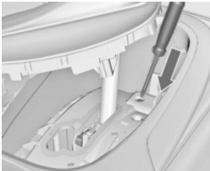
3. Schraubendreher so weit wie möglich in die Öffnung einführen und den Wählhebel aus der Stellung **P** bzw. **N** bewegen. Wenn **P** bzw. **N** wieder eingelegt wird, wird der Wählhebel wieder in dieser Stellung gesperrt. Ursache für die Stromunterbrechung von einer Werkstatt beheben lassen.
