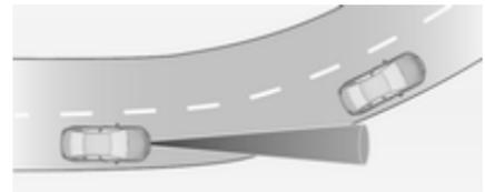
Ausgehend von der Zentrifugalkraft berechnet der adaptive Geschwindigkeitsregler einen voraussichtlichen Weg. Der berechnete Weg berücksichtigt die aktuellen Kurveigenschaften, kann jedoch keine späteren Änderungen der Kurvenspur vorhersehen. Das System kann daher ein vorausfahrendes Fahrzeug aus dem Erkennungsbereich verlieren oder ein Fahrzeug erkennen das sich nicht auf der verwendeten Fahrspur befindet. Dies kann beim Einfahren in eine
