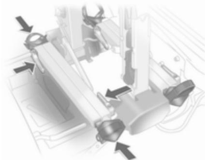
Entriegelungshebel drücken und Radaufnahmen vollständig bis zum Anschlag einschieben.
