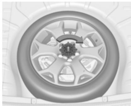
Ein beschädigtes Rad normaler Größe muss mit der Außenseite nach oben in der Reserveradaufnahme verstaut und mit der Flügelmutter gesichert werden.
