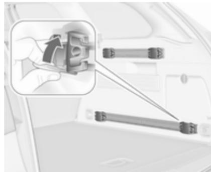
Die Griffplatte aufklappen, den Adapter in die obere und untere Nut der Schiene einsetzen und in die gewünschte Position bringen. Die Griffplatte zum Arretieren des Adapters nach oben schwenken. Zum Ausbau die Griffplatte nach unten drehen und aus der Schiene nehmen.
