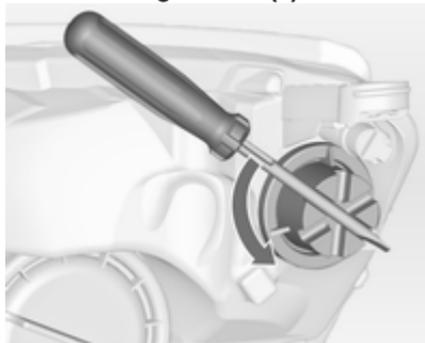
1. Die Kappe (3) nach links drehen und abnehmen. Den Schraubendreher zum Drehen der Kappe verwenden.
