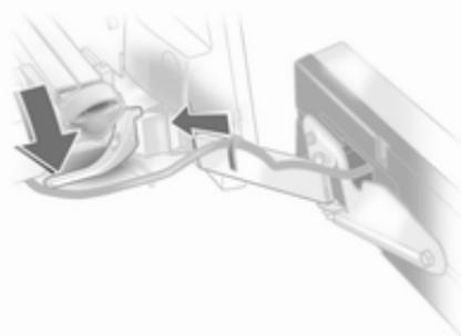
Den Spannhebel nach unten drücken und den Lampenträger in die Halterung drücken, bis er einrastet.
