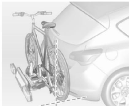
Das Fahrrad in Fahrzeuginnenrichtung ausrichten: Die Tretlagerfixierung etwas lösen.
