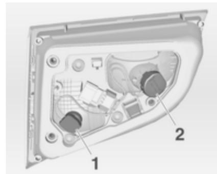
4. Die Lampenfassung durch Drehen gegen den Uhrzeigersinn ausbauen und die Lampe ersetzen. Hierzu die Lampe herausziehen oder leicht in die Fassung drücken und gegen den Uhrzeigersinn drehen:
