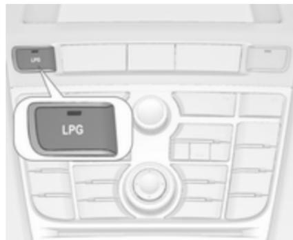
Durch Drücken der Taste **LPG** wird zwischen Benzin- und Flüssiggasbetrieb umgeschaltet, sobald die erforderlichen Parameter (Kühlmitteltemperatur, Gastemperatur und Mindestdrehzahl des Motors) erreicht sind. Die Anforderungen sind normalerweise nach etwa 60 Sekunden (je
