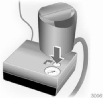
Wird der vorgeschriebene Reifendruck nicht innerhalb von 10 Minuten erreicht, Reifenreparaturset entfernen. Das Fahrzeug um eine Reifenumdrehung bewegen. Das Reifenreparaturset wieder anschließen und Füllvorgang für 10 Minuten fortsetzen. Wird der vorgeschriebene Reifendruck danach immer noch nicht erreicht, ist der Reifen zu stark beschädigt. Hilfe einer Werkstatt in Anspruch nehmen.
