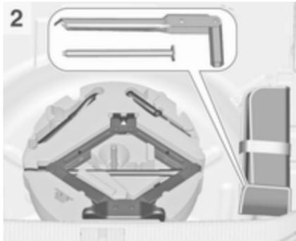
Der Wagenheber, das Wagenwerkzeug und die Abschleppöse befinden sich im Werkzeugkasten unter dem Reserverad im Laderaum. Der Radschlüssel und der Verlängerungsbolzen zum Befestigen eines beschädigten Rads (nur Fahrzeuge mit Not-Reserverad) befinden sich in der Werkzeughülle, die in der Nähe des Werkzeugkastens in der Reserveradaufnahme verstaut ist. Reserverad
