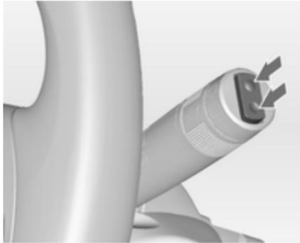
Zur Betätigung des Heckscheibenwischers Wippschalter drücken:
