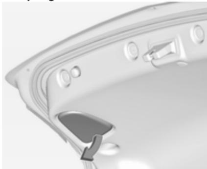
1. Hecktür öffnen und Abdeckung an der entsprechenden Seite abnehmen.
