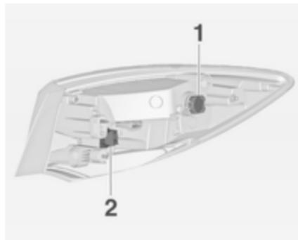
5. Die Lampenfassung durch Drehen ausbauen und die Lampe ersetzen. Hierzu die Lampe herausziehen oder leicht in die Fassung drücken und gegen den Uhrzeigersinn drehen:
