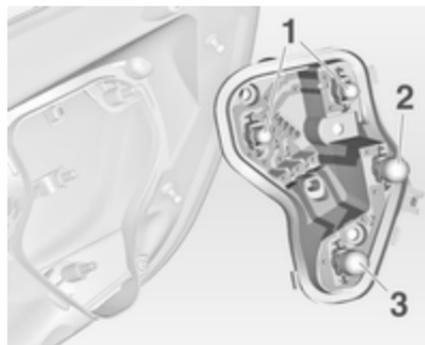
7. Die Lampe ausbauen und ersetzen. Hierzu die Lampe herausziehen oder leicht in die Fassung drücken und gegen den Uhrzeigersinn drehen:
