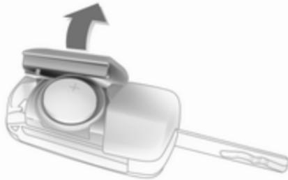
Schlüsselbart ausklappen und die Funkfernbedienung öffnen. Die Batterie austauschen (Batterietyp CR 2032). Die neue Batterie richtig einsetzen. Funkfernbedienung schließen und synchronisieren.
