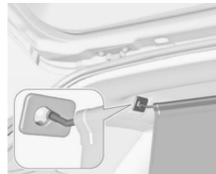
Im Dachrahmen befinden sich zwei Installationsöffnungen: Stange des Netzes an einer Seite einhängen und einrasten, Stange zusammendrücken und auf der anderen Seite einhängen und einrasten.
