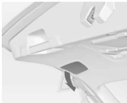
Die Nebelscheinwerfer bzw. das Rückfahrlicht (2) (je nach Seite) können über eine Abdeckung in der Hecktür ersetzt werden, ohne den Leuchtenszusammenbau auszubauen: Hierzu die Abdeckung abnehmen, die Lampenfassung drehen und die Lampe durch gegen den Uhrzeigersinn ersetzen.
