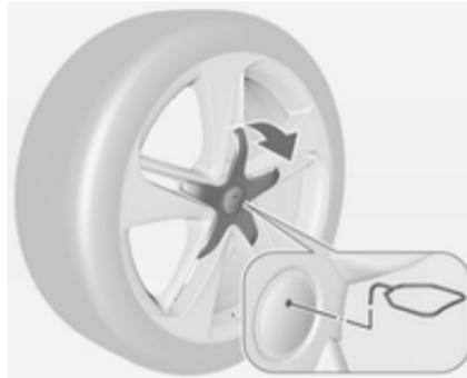
Leichtmetallräder mit Radzierkappen in der Mitte: Radzierkappe lösen. Dazu Abzieher in die Aussparung des Markenemblems stecken und daran ziehen. Wagenwerkzeug ⇨ 271.
