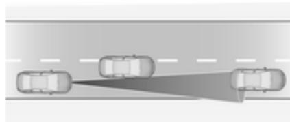
Wechselt ein anderes Fahrzeug auf die von Ihnen verwendete Spur, berücksichtigt der adaptive Geschwindigkeitsregler das Fahrzeug erst nach dem vollständigen Spurwechsel. Seien Sie bereit, das Bremspedal zu betätigen, falls dies erforderlich wird.
