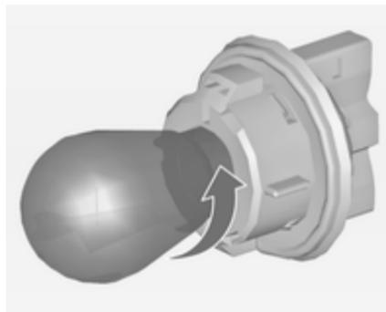
3. Lampe durch Drehen gegen den Uhrzeigersinn aus der Lampenfassung nehmen.
