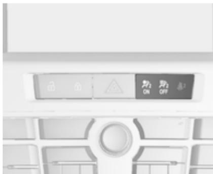
Wenn die Kontrollleuchte
