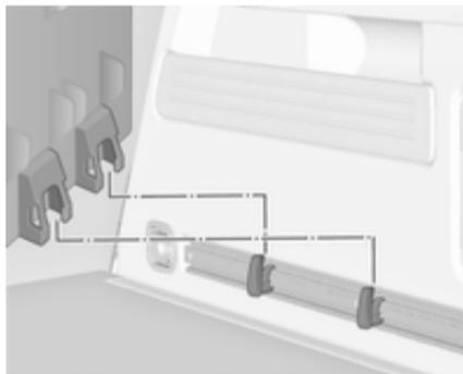
Wahlweise beide Haken in die untere Schiene einsetzen. Die unteren Halterungen der Box von oben in die unteren Haken einstecken.
