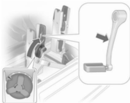
Bei Fahrrädern mit gekrümmten Tretkurbeln die Tretkurbelanlage vollständig hineindreihen (Position 1).
