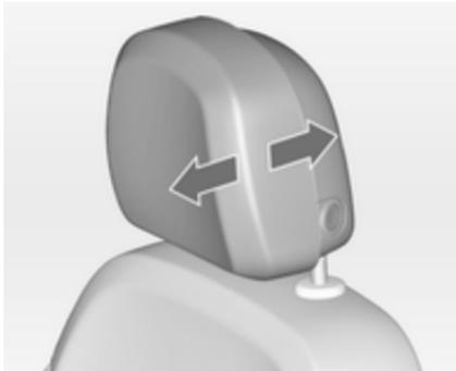
Für die Horizontaleinstellung Kopfstütze nach vorne ziehen. Sie rastet in verschiedenen Positionen ein. Zum Zurückstellen in die hintere Position die Kopfstütze ganz nach vorn ziehen und loslassen.
