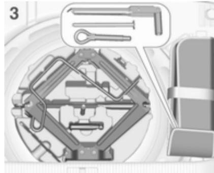
Der Wagenheber und das Wagenwerkzeug befinden sich im Werkzeugkasten unter dem Reserverad im Laderaum. Der Radschlüssel, die Abschleppöse und der Verlängerungsbolzen zum Befestigen eines beschädigten Rads (nur Fahrzeuge mit Not-Reserverad) befinden sich in der Werkzeughülle, die in der Nähe des Werkzeugkastens in der Reserveradaufnahme verstaut ist. Reserverad
