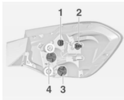
6. Die Lampenfassung durch Drehen gegen den Uhrzeigersinn ausbauen und die Lampe ersetzen. Hierzu die Lampe herausziehen oder leicht in die Fassung drücken und gegen den Uhrzeigersinn drehen:
