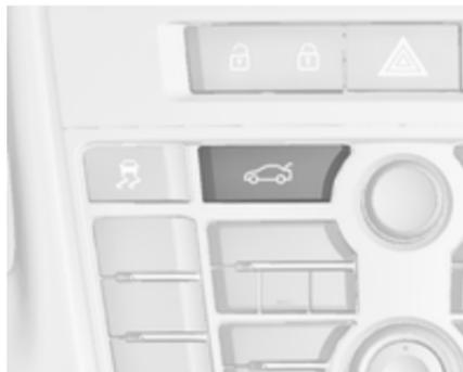
Wenn die Türen über die Zentralverriegelung verriegelt sind, kann der Laderaumdeckel nicht über die Taste
