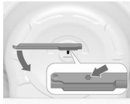
1. Den Sechskantschlüssel des Radschlüssels ansetzen und sichergehen, dass er fest auf der Schraube sitzt.
