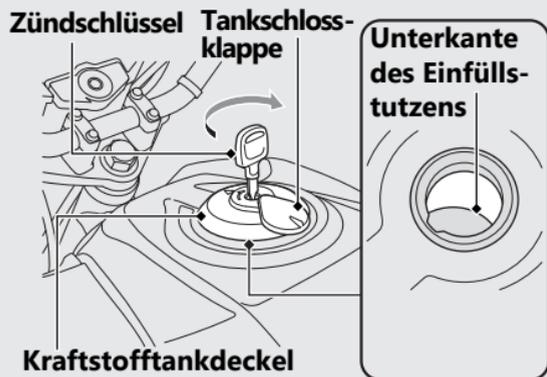
Füllen Sie nie mehr Kraftstoff als bis zur Unterkante des Einfüllstutzens ein.
